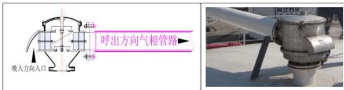
图 9.3-1 储罐废气收集方式
