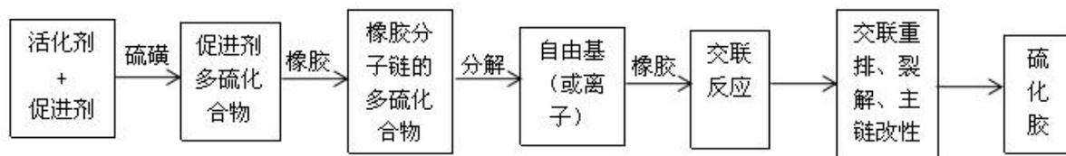
图 3.7-2 橡胶硫化反应过程
