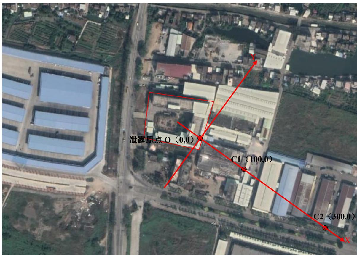
图 5.3-9 生产废水暂存罐泄漏预测点位分布示意图
