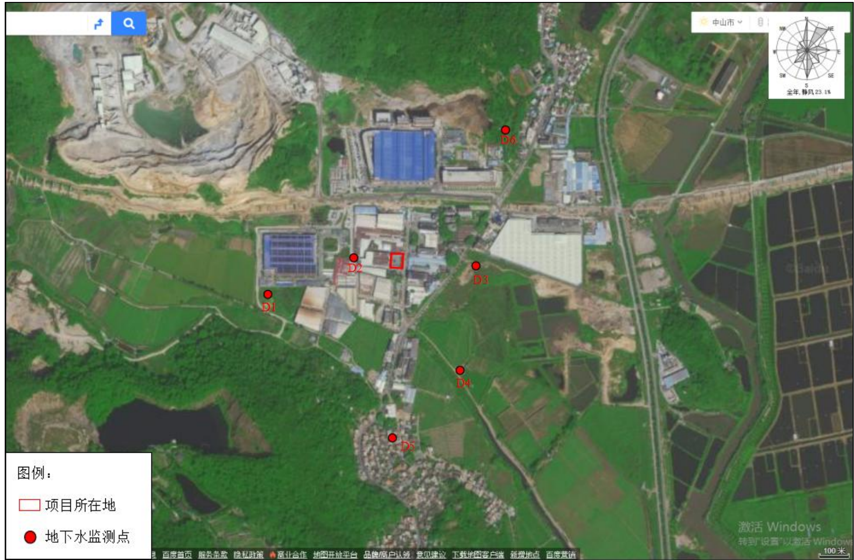
图 4.5-1 项目地下水现状监测布点图
