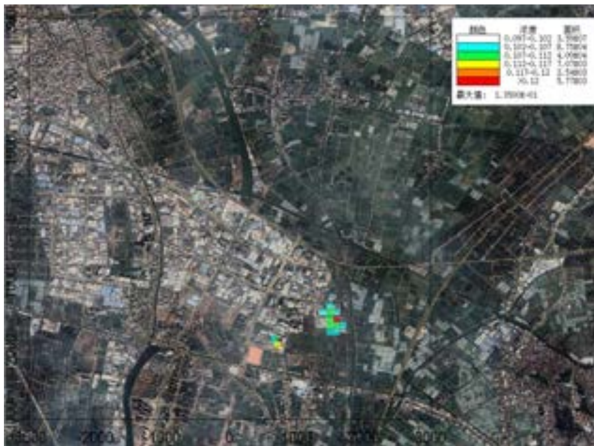
图5.4-10 PM_{10} 叠加区域环境质量后保证率日平均浓度预测等值线图
