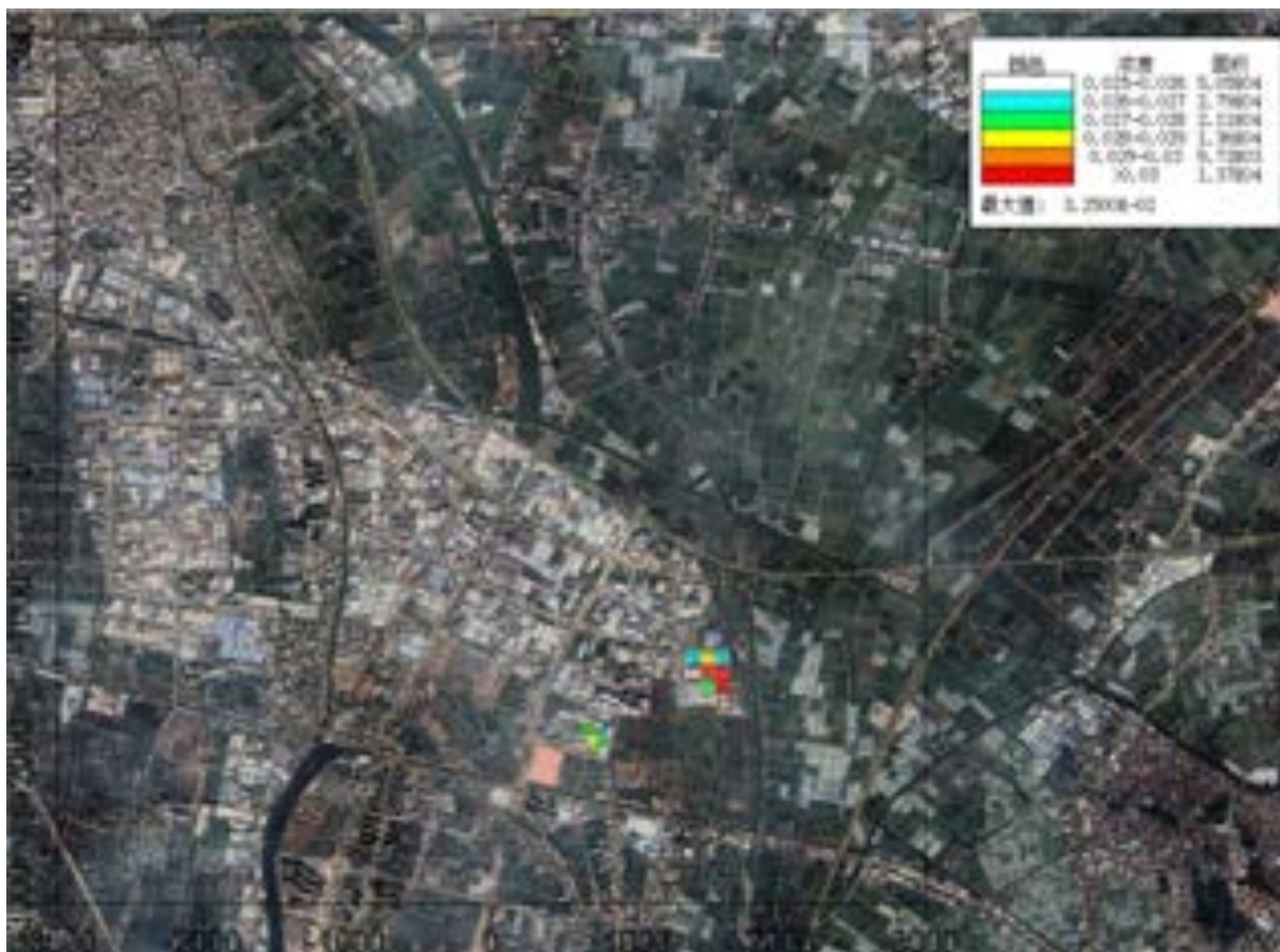
图5.4-13 PM2.5 叠加区域环境质量后保证率年平均浓度预测等值线图
