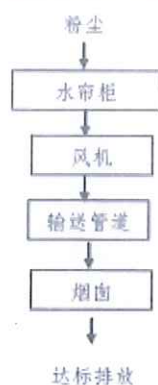
粉尘处理系统工艺简图
