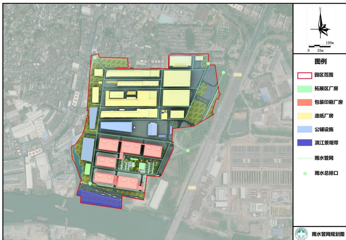
图 2.4-3 园区雨水管网示意图
