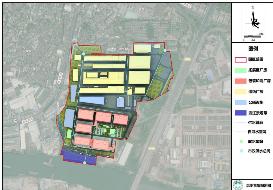
图 2.4-2 园区给水管网示意图
