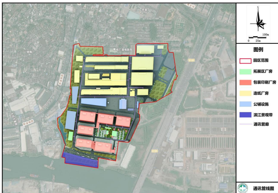
图 2.4-8 产业园通信管网规划布局示意图
