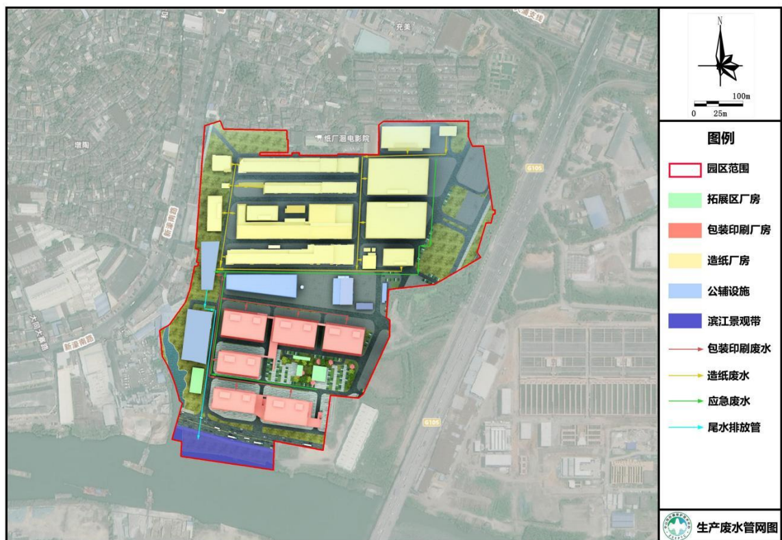
图 2.4-5 产业园生产废水管网规划布局示意图
