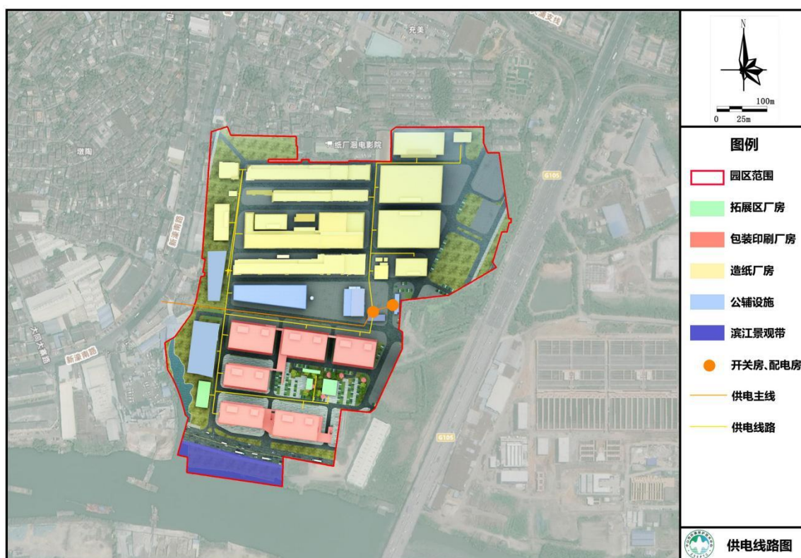
图 2.4-6 园区供电管网示意图
