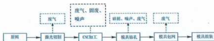
图 3-3 模具生产工艺流程图
