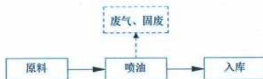
图 3-4 喷油线工艺流程图
