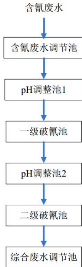
图 2.3-9 含氰废水处理工艺流程图
