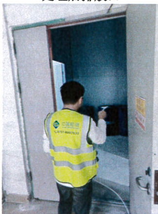
搅拌、倾倒、压料、投料、称料车间无组织废气采样
