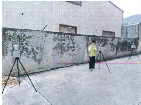
厂界无组织废气采样
