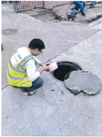
生活污水采样
